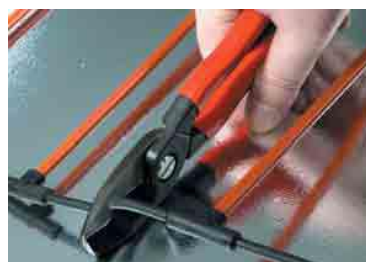
Рис.5. Пример правильного разделения стержневого мата
