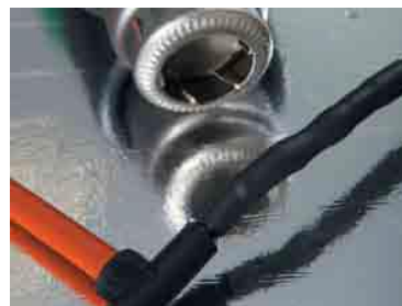
Рис.11. Усадка термоусаживаемой трубки техническим феном
