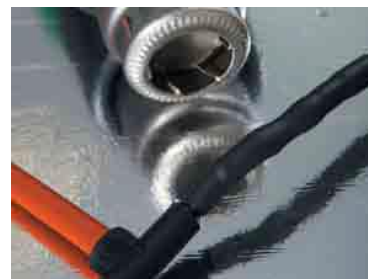
Рис.11. Усадка термоусаживаемой трубки техническим феном
